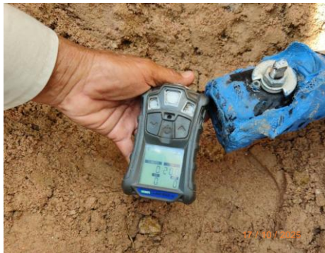
รูปที่ 2-49 เครื่องตรวจจับก๊าซ (Gas Detector) ในพื้นที่ ปฏิบัติงานต่อเชื่อม
